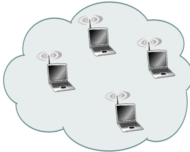
Quando un host si sposta dall'area di copertura di una stazione base a un'altra, cambierà il suo punto di collegamento con la rete globale. Questo processo è chiamato **handoff**.
